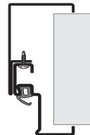
Umfassungszarge 2-schalig Zargenspiegel 33 oder 76 mm D-Typ 3
