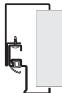
Ościeznica obejmująca 2-częściowa, lico ościeżnicy 33 lub 76 mm D typ 3
